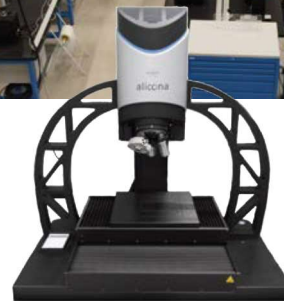
Brüker Alicona - InfiniteFocus G5+ (mesures de rugosité)
